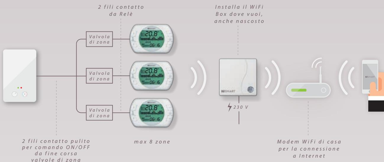
**NB:** Nella sostituzione, nel caso in cui sui vecchi termostati siano presenti più di 2 cavi, vanno individuati e collegati i soli cavi di acceso/spento. Il termostato BeSMART non necessita alimentazione da rete elettrica, in quanto funziona con batterie proprie.
