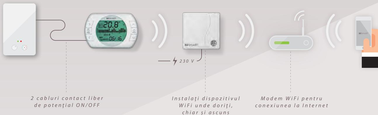
**NB:** La înlocuire, în cazul în care la vechile termostate sunt prezente mai mult de 2 cabluri, trebuie identificate și conectate doar cablurile de pornire/oprire. Termostatul BeSMART nu necesită alimentare de la rețeaua electrică deoarece funcționează cu baterie proprie.
