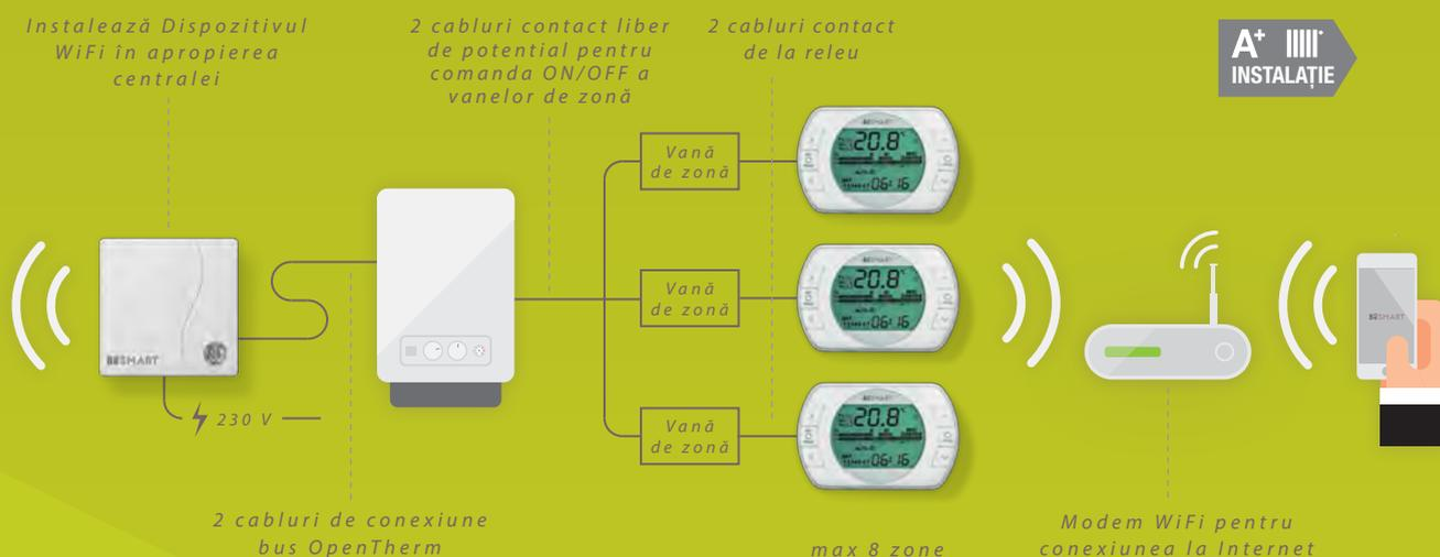
**NB:** La înlocuire, în cazul în care la vechile termostate sunt prezente mai mult de 2 cabluri, trebuie identificate și conectate doar cablurile de pornire/oprire. Termostatul BeSMART nu necesită alimentare de la rețeaua electrică deoarece funcționează cu baterie proprie.
