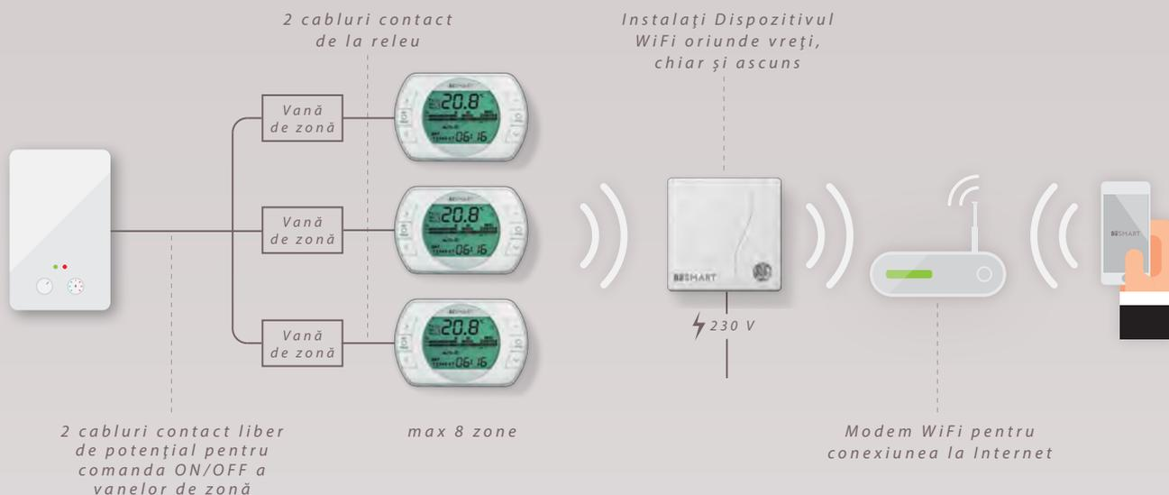
**NB:** La înlocuire, în cazul în care la vechile termostate sunt prezente mai mult de 2 cabluri, trebuie identificate și conectate doar cablurile de pornire/oprire. Termostatul BeSMART nu necesită alimentare de la rețeaua electrică deoarece funcționează cu baterie proprie.
